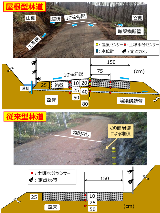
図1 埋設したセンサーの配置図
