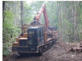
フォワーダによる末木枝条 積込・運搬
