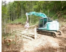
ハーベスタによる全幹材の 枝払い・玉切り作業
