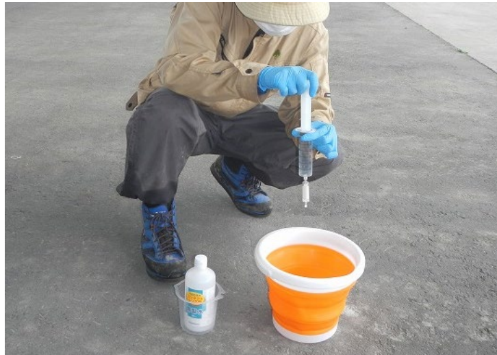
写真 4.1 現地でのネガティブコントロール用サンプル作成 （シリンジを用いたろ過の例：精製水使用）
