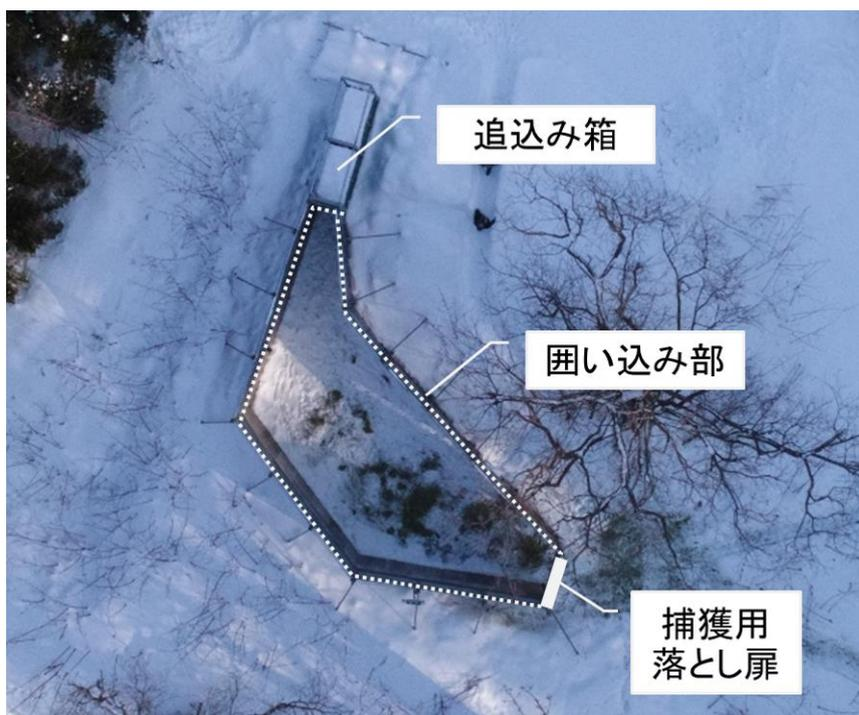
図 8. 代表的な囲いわなの構造図
