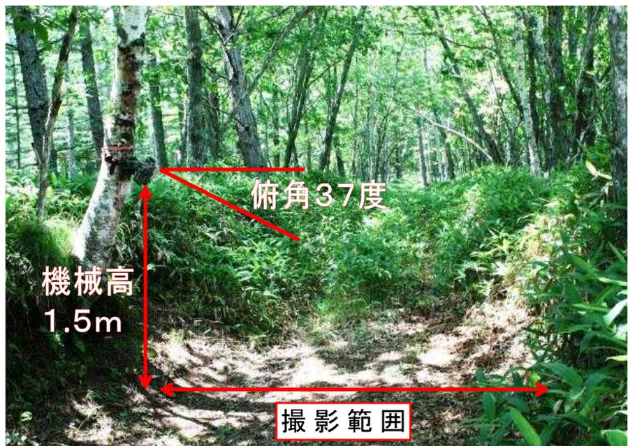
自動撮影カメラの設置場所は、林道網、支線、作業道、廃道などに面した人の出入りの少ない場所とし、けもの道等のフィールドサインが多い箇所や周囲の状況に留意して決定した。自走撮影カメラは設置高1.5m、俯角37°で設置し、シマリス以上の大きさの動物が撮影されるように調整した。
