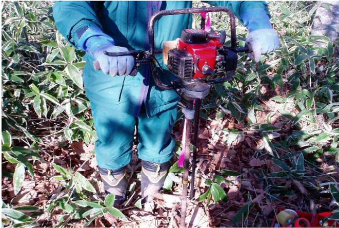
エンジン付きオーガ(掘削機)により、穴を掘る。
