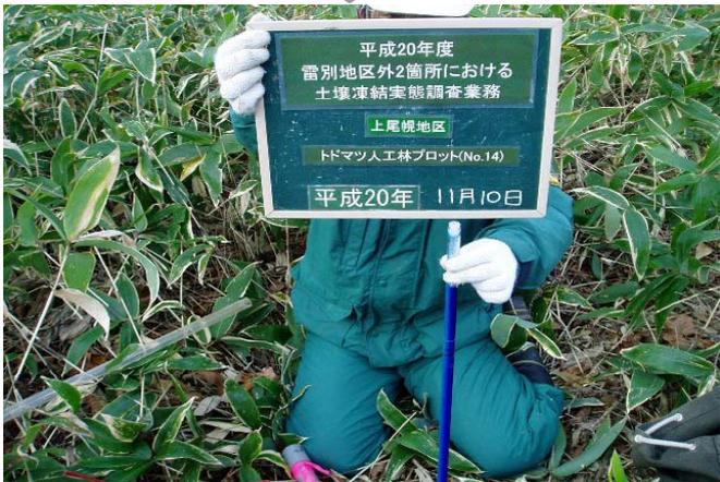
保護管および測定管を埋設する。
