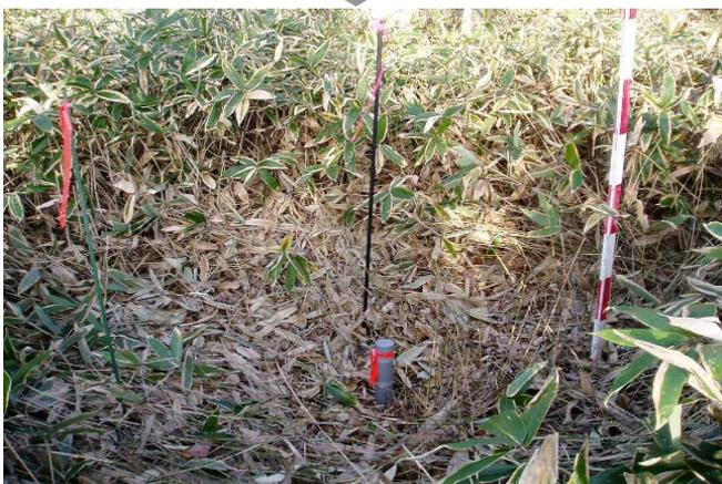
測定管の1m以内に紅白のポールを立てる。また、紅白のポールと測定管を結ぶ対角線上に竹竿を立て、測定管の位置を明確にする。この赤白ポールには、メジャーを貼り付け、定位置で積雪深を測定できるようにした。
