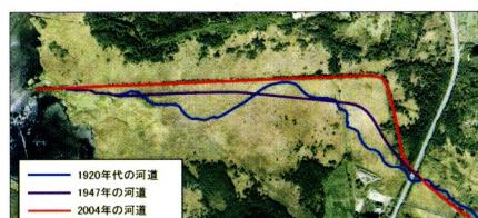
図4 達古武川の河道の変遷(2004年撮影空中写真上に表示)
