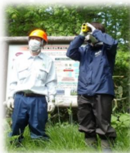
左の写真:レーザー測定器で樹高を測定 右の写真:直径巻尺を使い直径を測定 (2023年5月20日 植生観察会)
