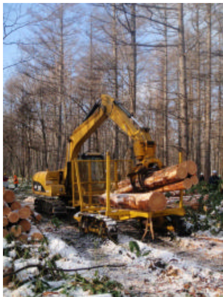
4mの長材の積み込み
