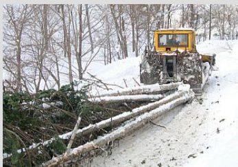
トラクターによる集材作業
