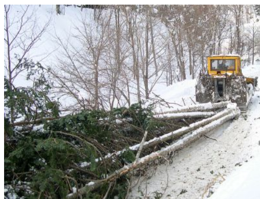
ブルドーザによる集材作業
