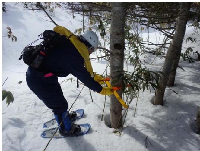
↑ 林内での調査の様子。ノギスを大きくしたような【輪尺（りんじゃく）】という道具を使い、木の太さを測ります。
