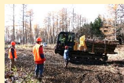
伐倒した木材を フォワーダで搬出
