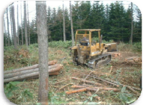
【間伐ブル集材作業】
