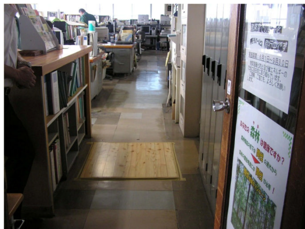
写真－2 フローリングの耐久試験
