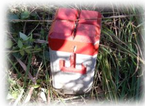
国有林の境界標 (コンクリート標)
