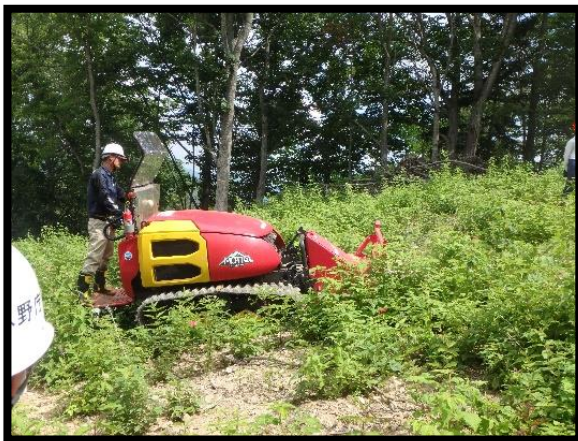
造林機械による下刈り作業
