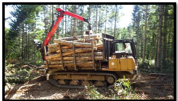
フォワーダへの積み込み・運搬
