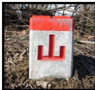
国有林の境界標 (コンクリート標)
