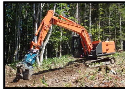
グラップルレーキによる機械地拵 (上川南部森林計画区)
