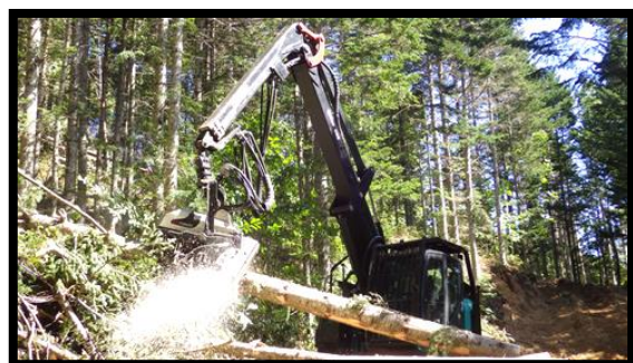
林業機械による玉切作業
