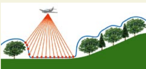
航空機レーザー測量のしくみ
