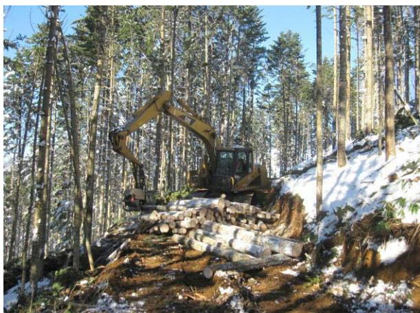
プロセッサによる造材作業
