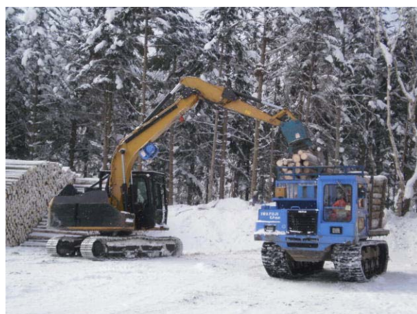
フォワーダによる集材作業 (グラップルによる巻立)
