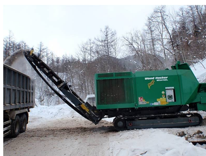
移動式チッパーによる未利用材のチップ化
