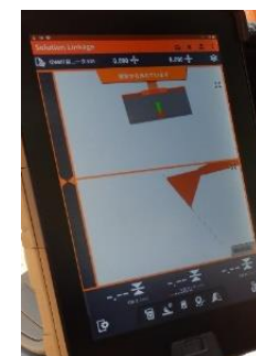
土木機械と設計図が連携することで作業すべき位置を運転席でモニターしながら作業可能
