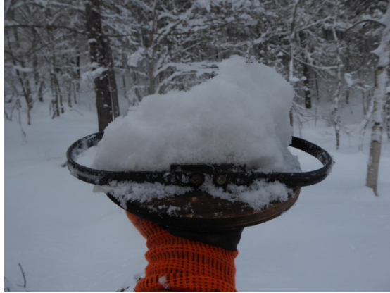
写真 7-24 空落ちが発生したくくりわなの上に残された雪のかたまり（2月25日） エゾシカはこの雪のかたまりの上から足を乗せたため、くくりわなが稼働しても ワイヤーが足にかからなかったと推察された
