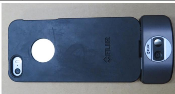
写真 5-10 携帯電話に接続したサーモグラフィカメラ
