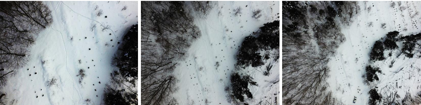
写真5-1 高度によるエゾシカの足跡の写り方の違い 左) 高度50m 中) 高度75m 右) 高度100m
