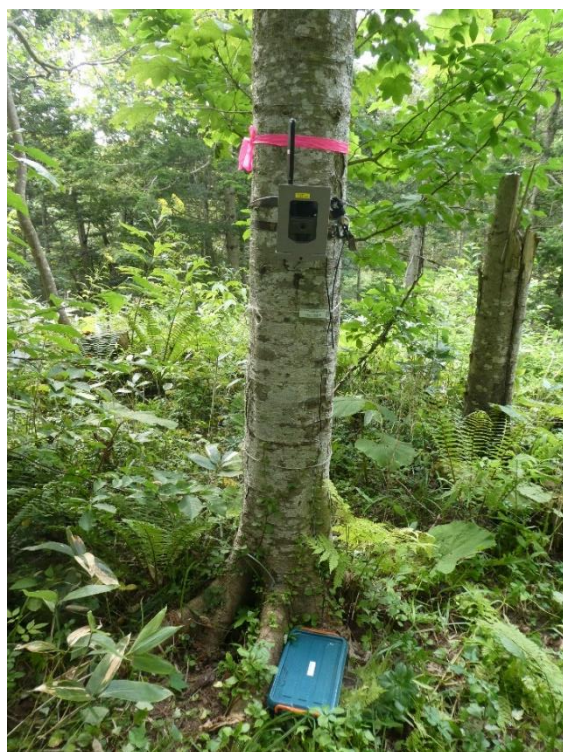
写真 5-1 エゾシカ生息状況調査 自動撮影カメラ設置状況 (左上) 非通信型カメラ (右上) IoT カメラ (下) IoT カメラとバッテリーボックス
