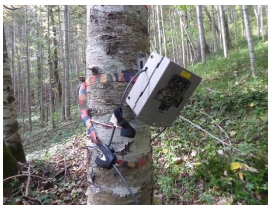
写真 6-3 点検時に傾いていたカメラ
