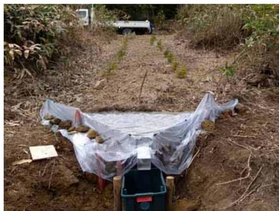
写真5 流出土砂採取器
