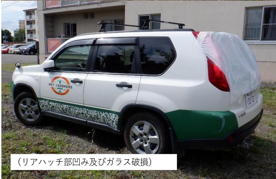
(リアハッチ部凹み及びガラス破損)
