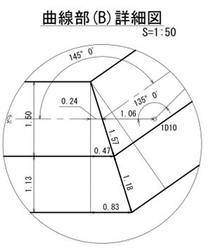
木製側壁工設置図 (桁倉式)
