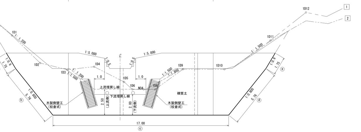
木製側壁工 床掘・埋戻し計算図
