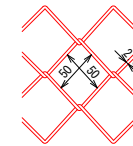
被覆金網 S=NON φ2.0×50×50 表面処理: Z-GS3 飽和ポリエチレン被覆
