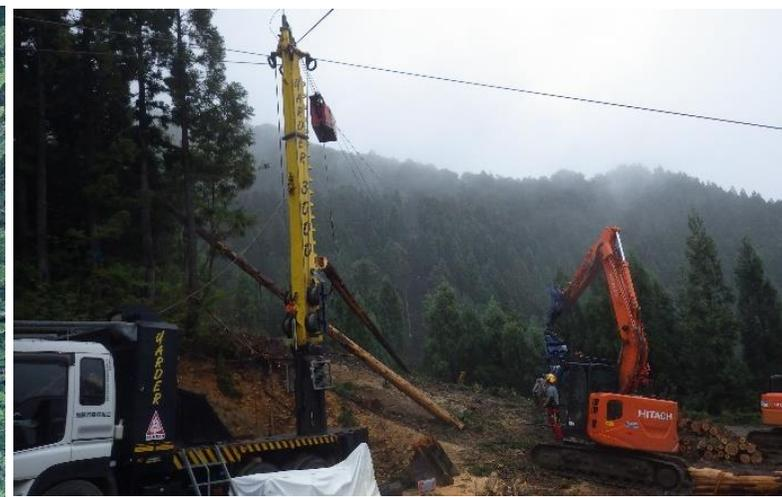
作業道とタワーヤーダ-を併用した集材
