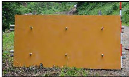
写真1：長野県産材ヒノキ型枠合板
