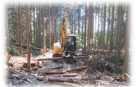
(プロセッサによる集造材作業)
