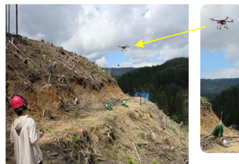
最大搭載重量15Kgの林業用ドローンによる苗木運搬
