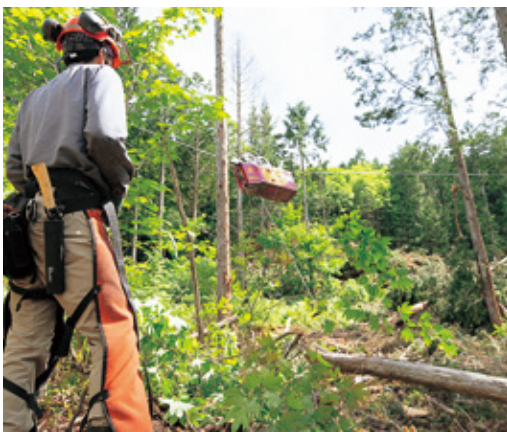
高性能自走式搬器による架線集材
