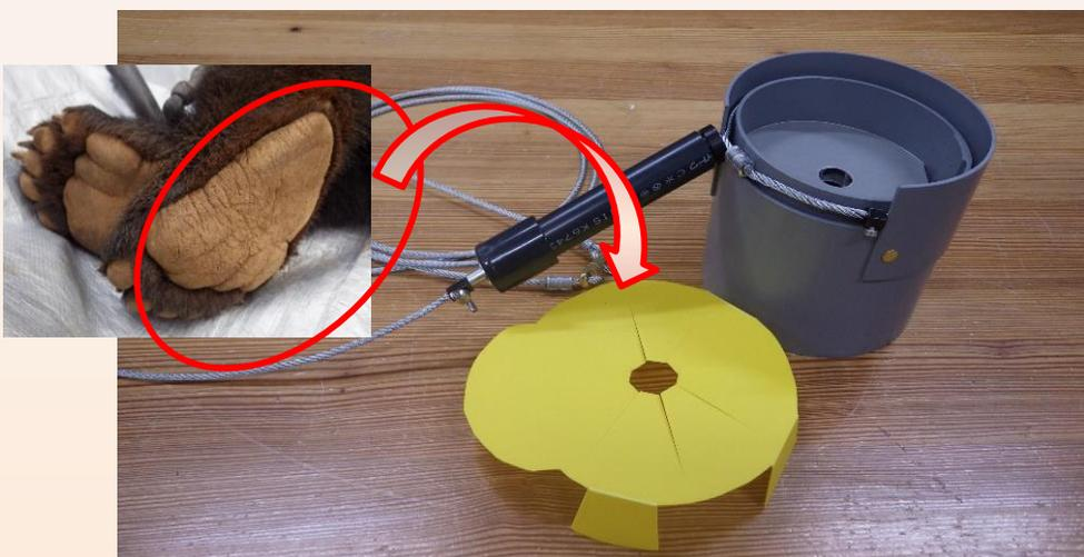
クマ踏み抜きを防止するプレートと踏み込み式わな
