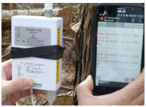
電波調査器による電波状況の確認
