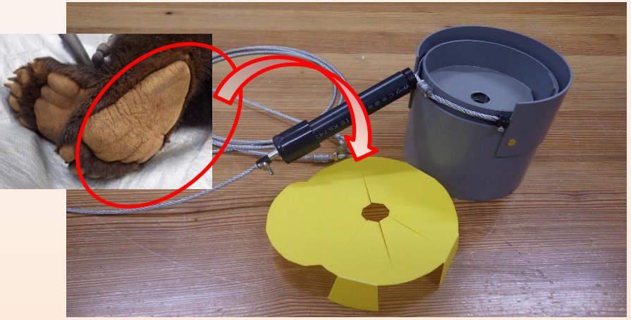
クマ踏み抜きを防止するプレートと踏み込み式ワナ
