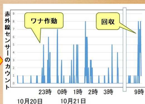
シカの動きを赤外線センサーによるカウント数で見える化し、罠に掛かっていることを現場外でも確認が可能に
