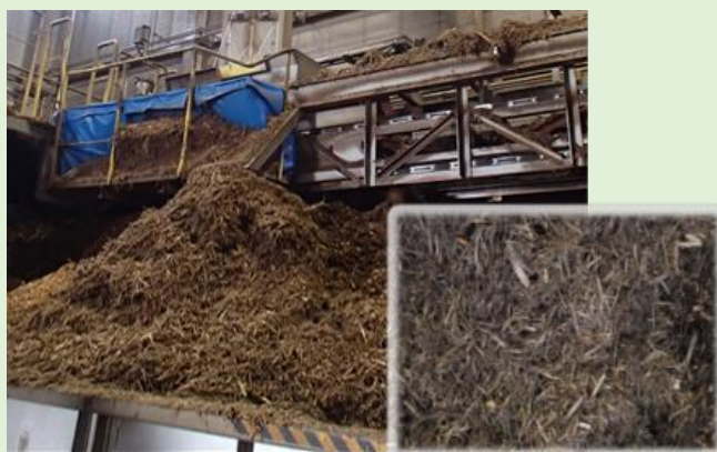
Dバイオマス燃料用に粉碎されたチップ
