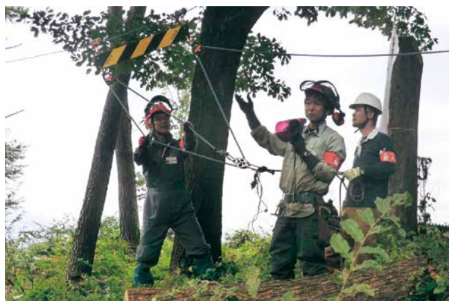
簡易索道を用いた集材のデモンストレーション
