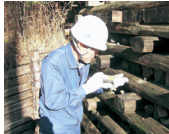
打込抵抗法による調査
