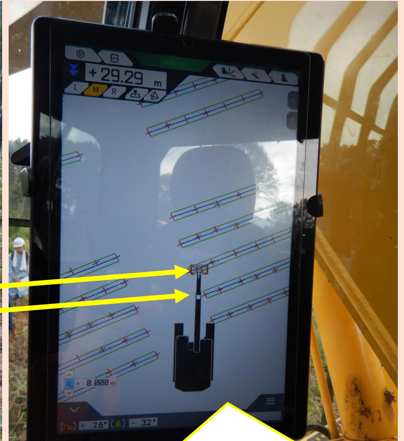
【運転席のモニター】 重機と植栽木の位置が正確に表示されています。
