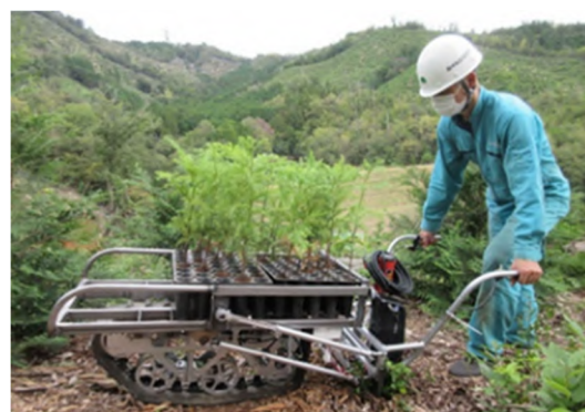
電動一輪車での運搬イメージ(コンテナ苗) コンテナ苗のほか、獣害用の防護柵資材等の運搬の省力化、軽労化も検証します
