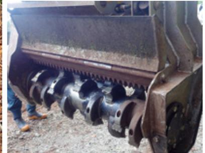
あらかじめ、機械幅を見越した走行路を確保しておく、クラッシャーのヘッド部分の幅は1m弱なので、通常の植栽間隔であればクラッシャーによる苗木の間の刈払いが可能です。
