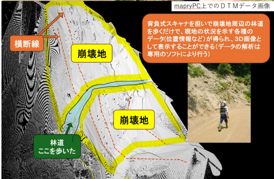
背負式レーザースカナで取得したデータから3D画像化した崩壊地
