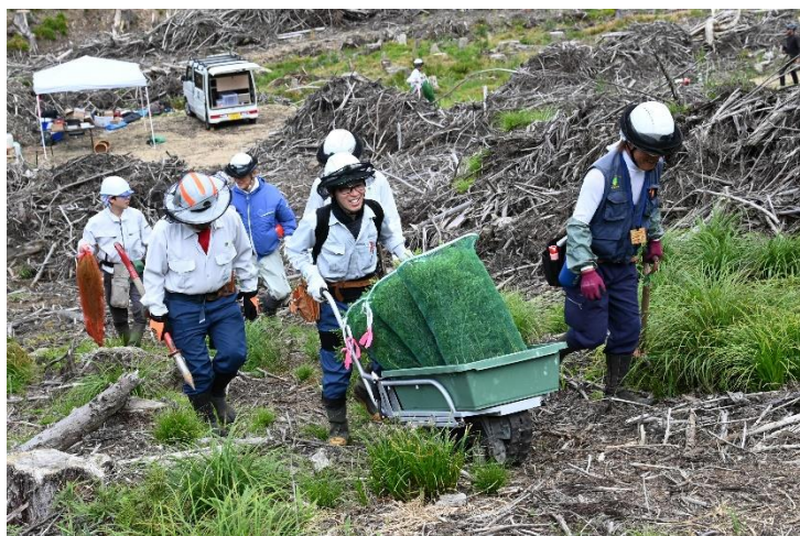
職員が支える程度で傾斜を登っていく電動式クローラ型一輪車
