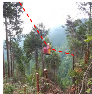
集材線(赤の点線)と木材を吊る搬器
