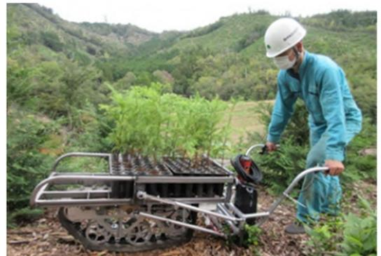
電動一輪車での運搬イメージ(コンテナ苗) コンテナ苗のほか、獣害用の防護柵資材等の運搬の省力化、軽労化も検証します
