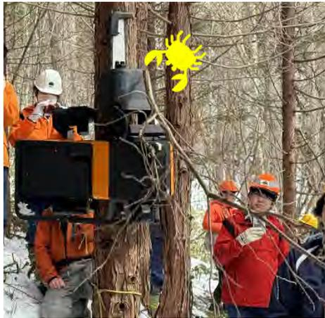
(右の写真は、樹木を挟むようにセットした枝打ち機が回転しながら上昇し、枝を自動判定してチェーンソーで切断を行う様子)
