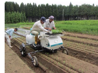
図1 タマネギ用移植機を用いたスギ苗の植え付け作業
