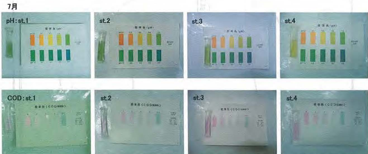
写真2-1-1 パックテストによるpHおよびCODの測定結果(7月)
